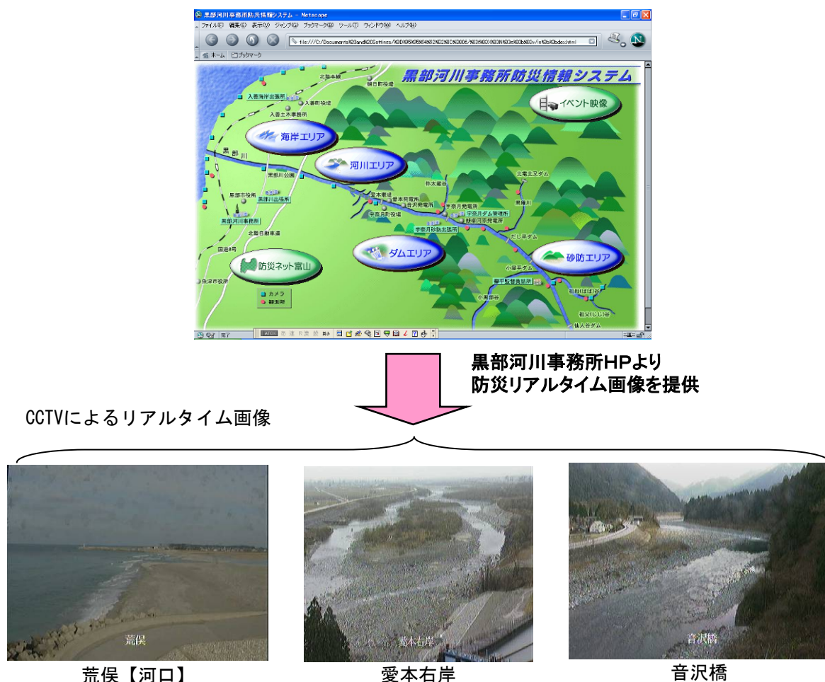
図 3-36 CCTV カメラによる遠隔監視
