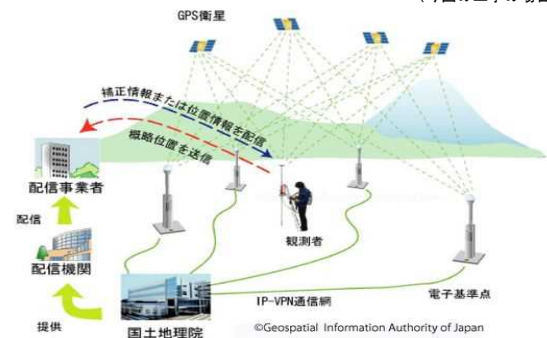
図3 ネットワーク型RTK-GPS 測位について
