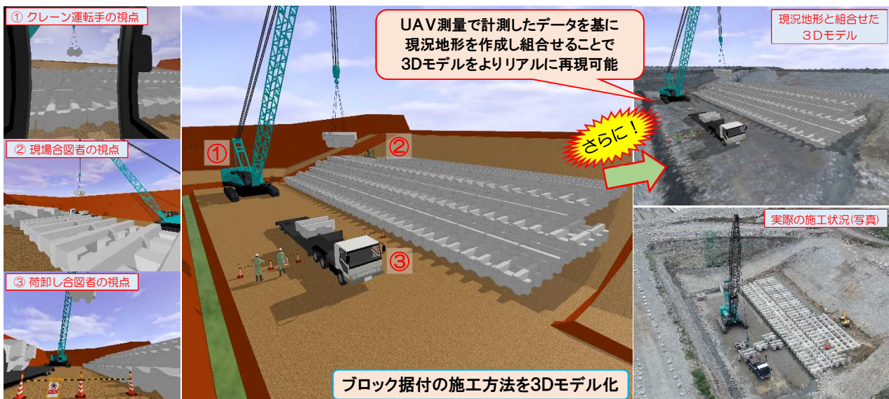
図7 CIMモデルによる施工方法・危険箇所等の可視化
