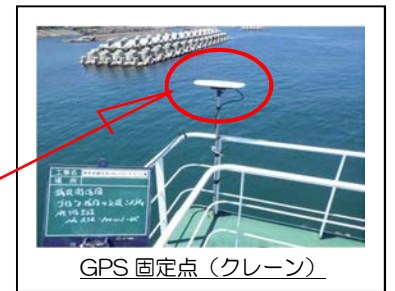
【 ブロック据付支援システム概要図 】
