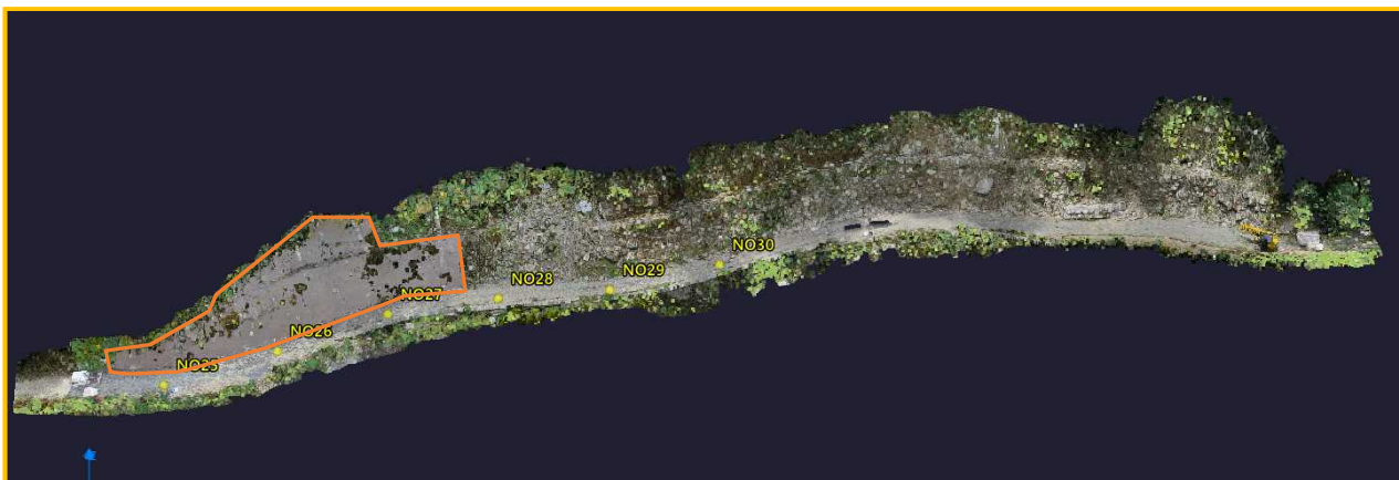
法面吹付箇所出来形測量写真
