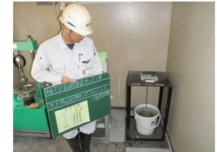
【アスファルトマット比重試験
