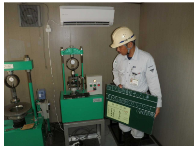
【アスファルトマット曲げ試験
