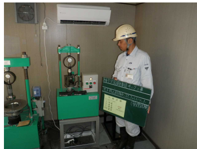
【アスファルトマット圧縮試験
