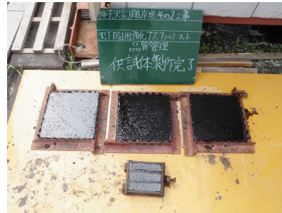
【アスファルトマット供試体】
