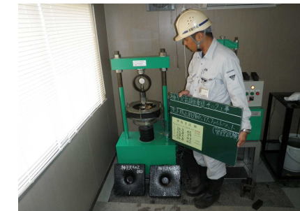
【アスファルトマット押抜き試験
