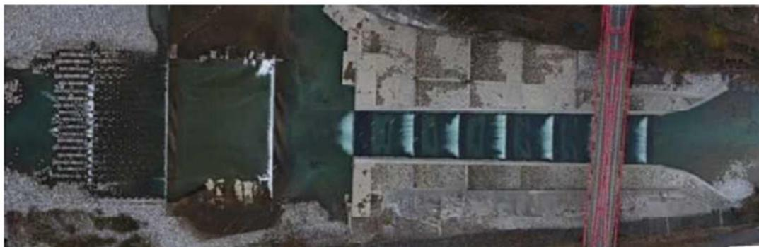
写2-1 UAVを使った空中写真による愛本常水路・床止め工の定点観測
