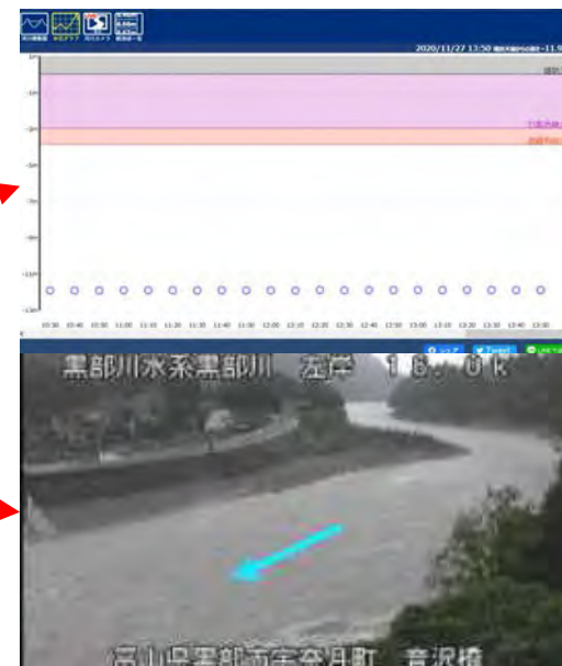
危機管理型水位計の水位情報（上）CCTV画像（下）
