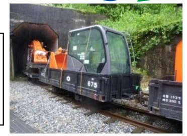
唯一の輸送手段である黒部峡谷鉄道による機材・資材等の分解輸送
