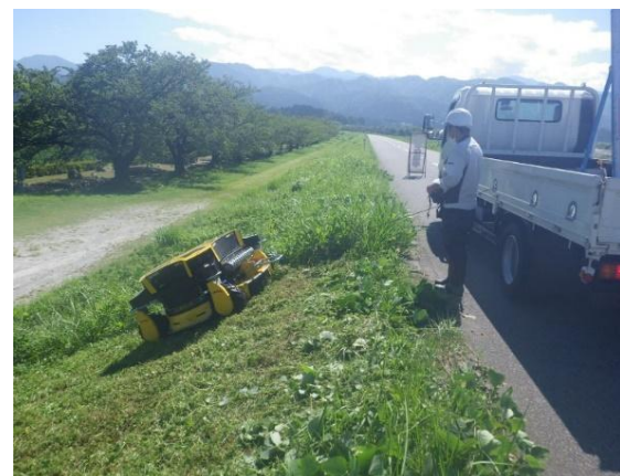
スパイダー * 石張護岸に適用可能な除草機械
