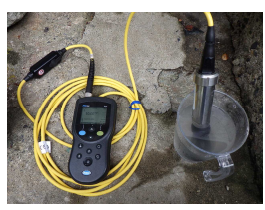
DOメーターによる計測
