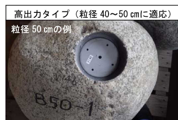
トレーサー（発信器を埋め込んだ礫）の例
