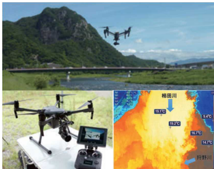
赤外線カメラ付きドローンによる上空からの水温調査
