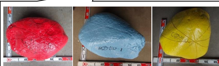
図2. トレーサー② (着色+ライン加工)
