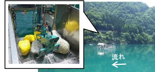
図4. トレーサーの事前設置の様子
