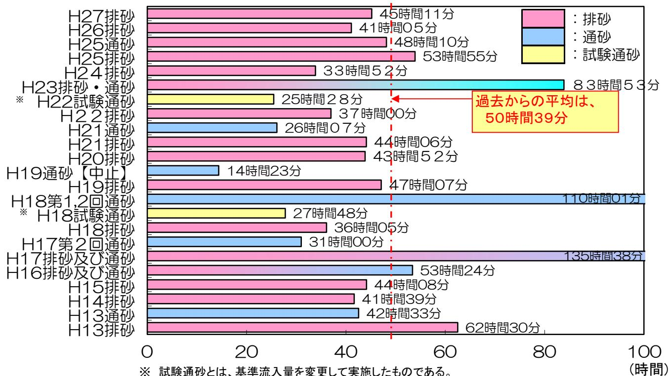
連携排砂・通砂による愛本合口堰堤の取水停止時間は平成13年度からの連携排砂・通砂の開始以来、過去23回で9番目に長く、45時間11分で終了(H19通砂を除く)
