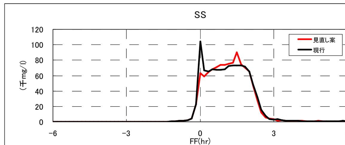
自然流下開始直前から水位低下速度を抑制することにより、SSピーク値を抑制することが可能であると考えられる。
