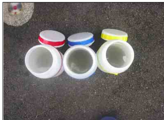
セジメントトラップ採取容器には2Lポリ瓶を使用(口径8cm、胴長24cm)
