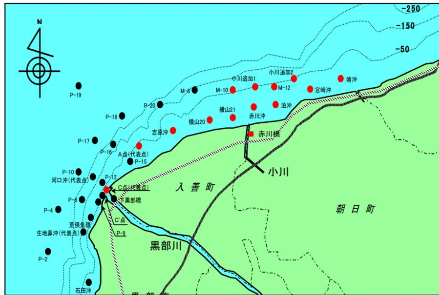
方法： 排砂時の海域での採水と同様に、バンドーン採水器を用いて、水深1mの表層水を採水し、SS及びCODを分析する。
