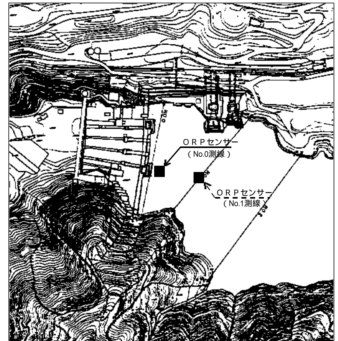
上記2箇所、湖底の約50cmに埋め込み
