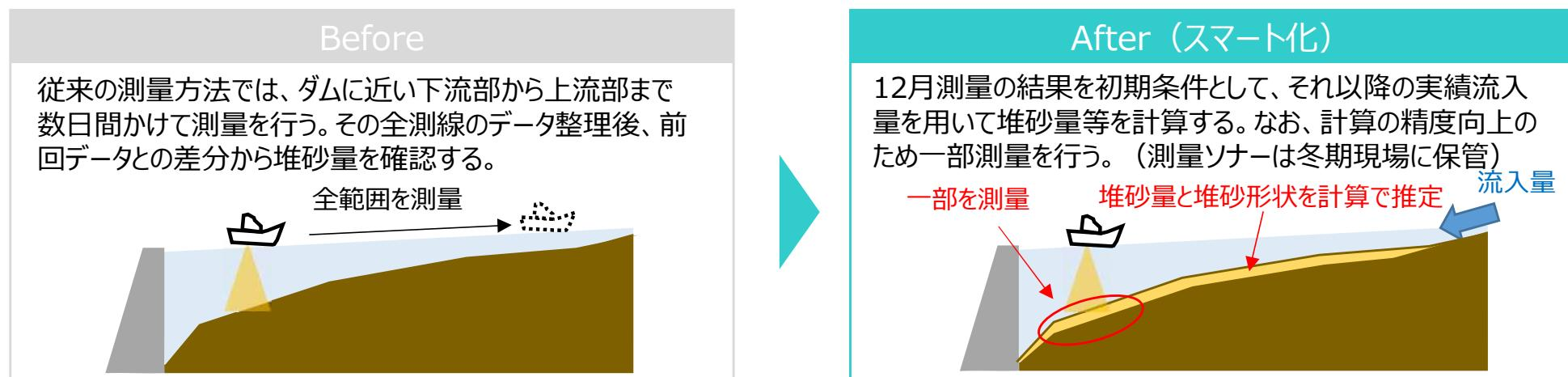
堆砂測量をスマート化することにより、黒鉄開通時期に依存せず堆砂量の把握が可能になるとともに、現地作業の短縮・軽減が可能になる。
