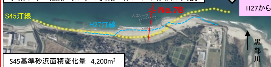
令和3年 黒部川からの供給土砂により砂浜が回復
