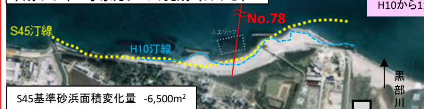
平成27年 黒部川からの供給土砂により砂浜が回復
