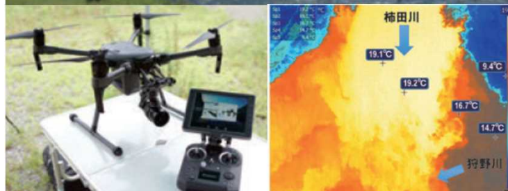
赤外線カメラ付きドローンによる上空からの水温調査
