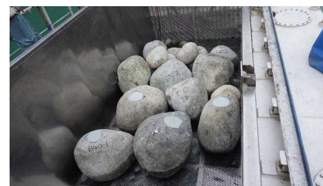
図-2 トレーサー (発信器埋め込み済みの礫(10~50cm))
