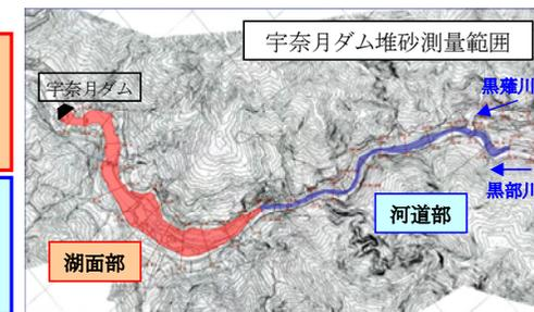
↓ 排砂期間中に河道部を測量する場合、天候や流況に左右され実施できない場合が多い。その間に土砂移動等があると、堆積土砂状況が変化するため、短期間でかつ効果的な測量を実施することが必要となる。
