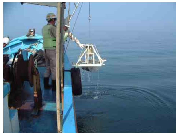
採泥状況（排砂実施機関）
