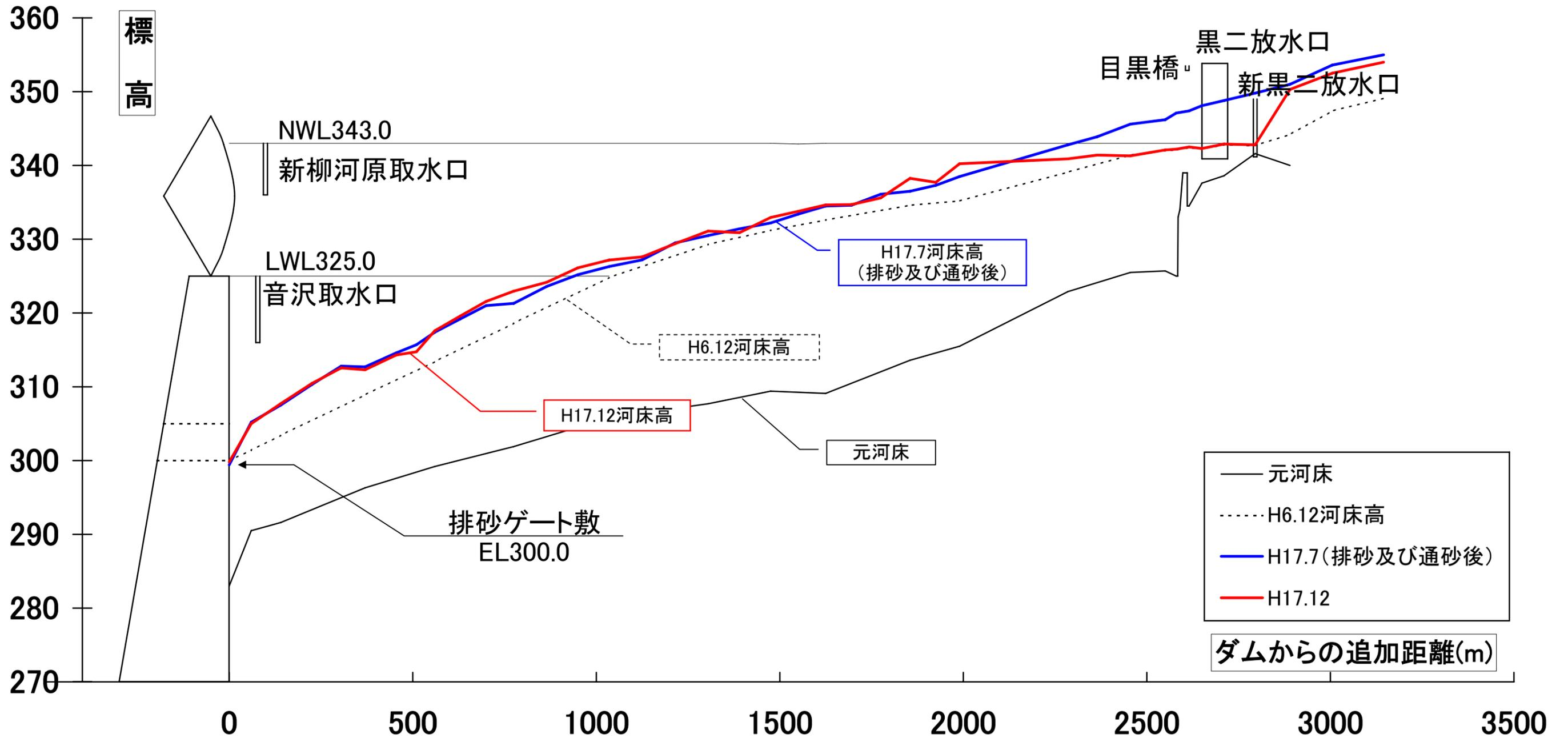
平成18年度 出し平ダム排砂予測(自然流下を継続した場合の排砂量・時間)
