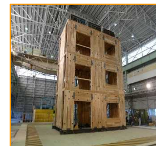
▲ CLTを利用した建築物の実大震動台実験
