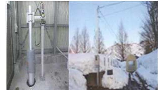
▲ 地下水観測機器の設置（地盤沈下対策）
