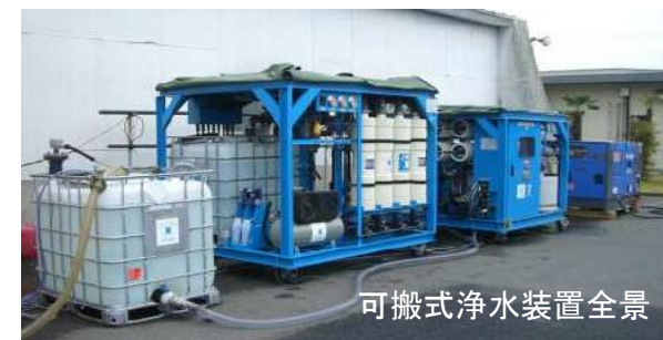
可搬式浄水装置（水資源機構）2台で作った水を北陸地整運搬
