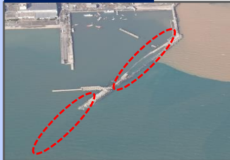
防波堤の破壊
