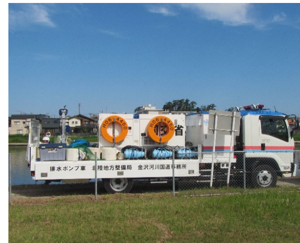
▼派遣した排水ポンプ車(R06-4450)
