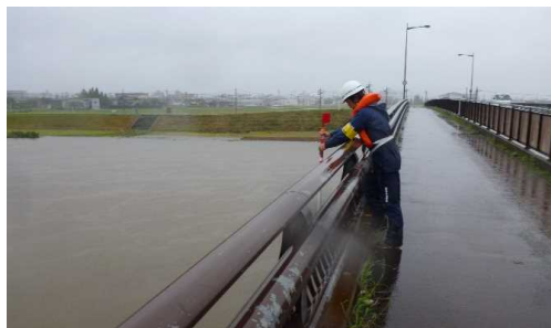
高水流量観測状況 (浮子投下)
