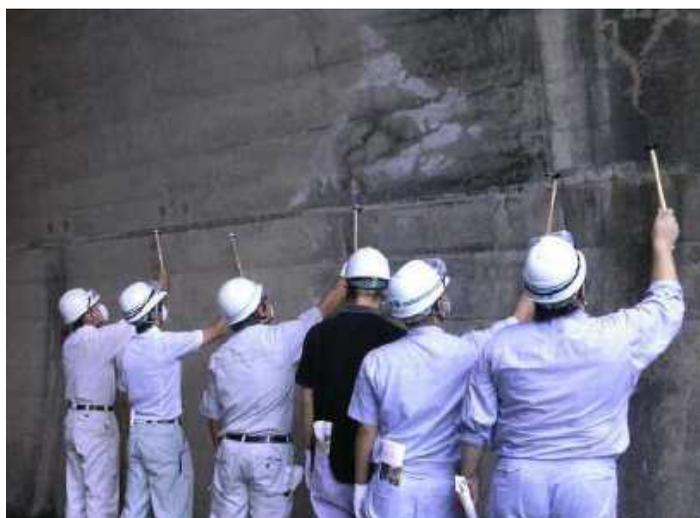
テストハンマーによる打音点検の状況
