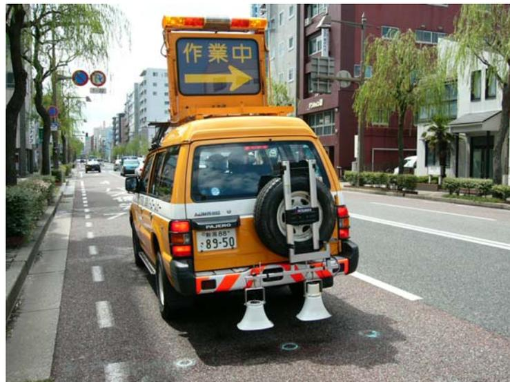
路面反射音測定状況
