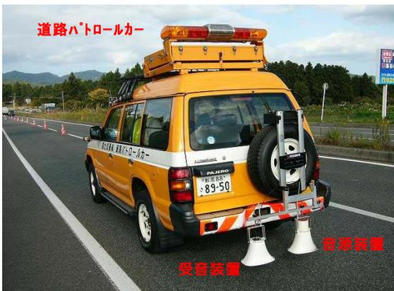
路面反射音測定装置の車載状況
