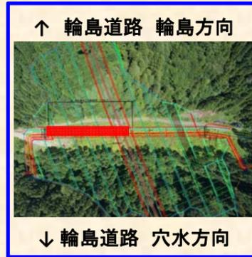
本工事は、能越道の長沢地区において、盛土部内となる林道のために、アーチカルバートボックスを新しく構築する工事です。全長L=134.5mのうち、県道側L=74.75mが施工範囲です。工事期間中は、大型工事用車両の出入り等ご迷惑をお掛けしますが、無事故・無災害で工事を進めてまいりますので、皆様のご理解・ご協力をお願いいたします。(着色部が工事範囲)
