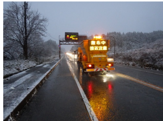
凍結防止剤散布車の出動状況 （国道8号 津幡町坂戸）
