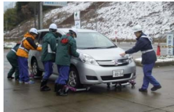
タイヤ付きジャッキを 用いた車両移動
