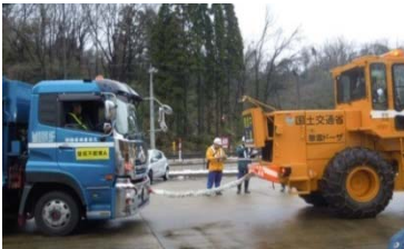
除雪車による 大型トラックの牽引
