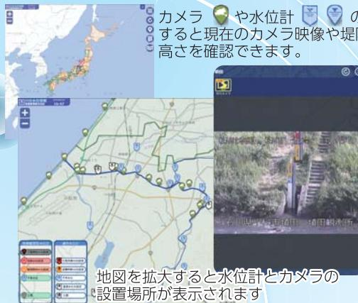
カメラや水位計のアイコンをクリックすると現在のカメラ映像や堤防天端からの水面までの高さを確認できます。
