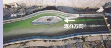
分水路方式の決定に際しては大規模な模型実験による技術的な検証による安全性の検証が行われました。
