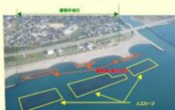
なぎさりフレッシュ事業により緩い階段形状の緩傾斜堤が完成し、沖合には人工リーフを整備しました。今後、人工リーフを整備した区間において砂浜が安定したことを確認した上で離岸堤を撤去し美しい景観を作り上げていきます。
