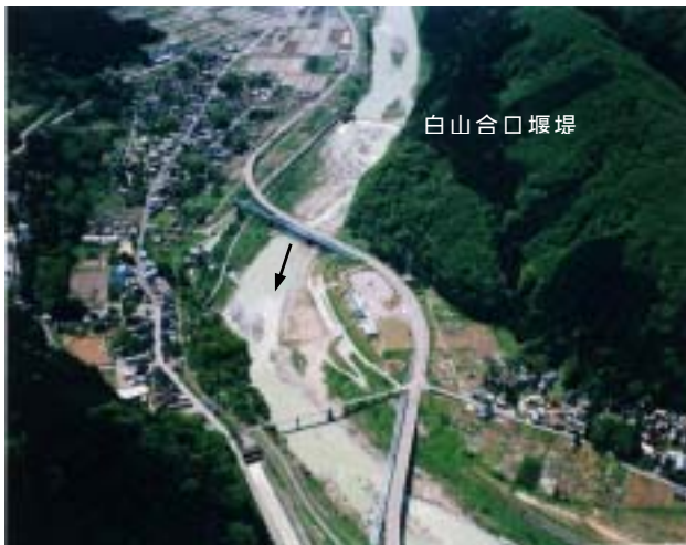
下流部 川北大橋下流付近 (扇状地部：霞堤、淺筋の変化が激しい)
