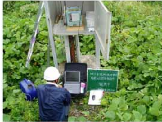
図 81 地下水位・流向観測
