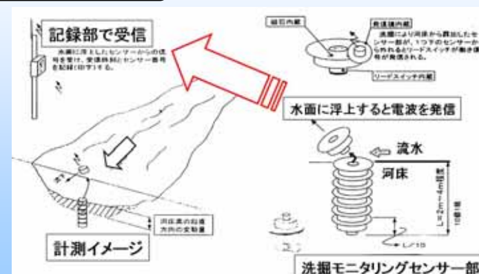
洗掘センサーを用いた観測(例)
