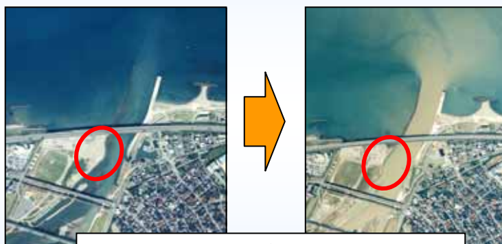
洪水により砂州が消失(H10.9出水)
