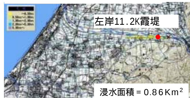
霞堤あり、左岸12.0K破堤
