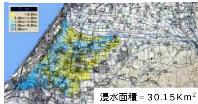
霞堤無し、左岸5.8K破堤
