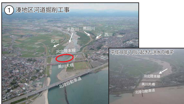
河道掘削による洪水時の通水能力向上
