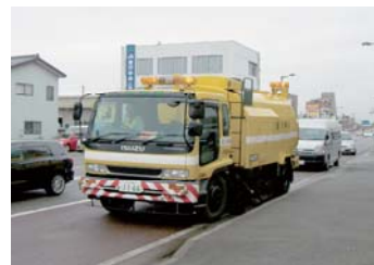
路面清掃車による清掃
