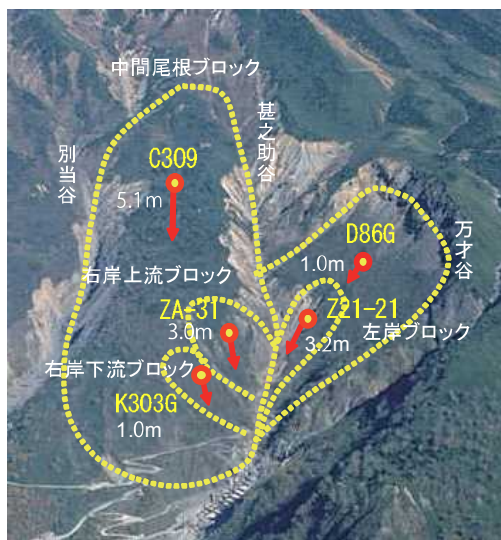
白山南西部の手取川上流基之助谷地すべりの全景 赤矢印で示した方向に、地すべりブロックが移動しています
