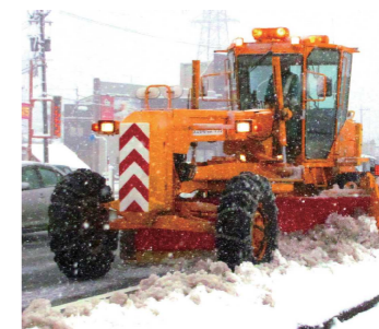
圧積を排除する除雪グレーダー
