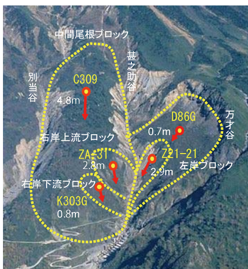
白山南西部の手取川上流甚之助谷地すべりの全景 赤矢印で示した方向に、地すべりブロックが移動しています
