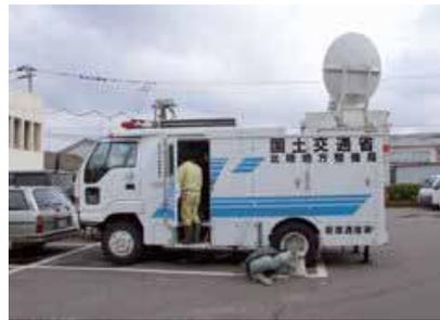
被災現場の情報収集に欠かせない衛星通信車
