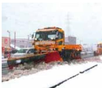
路面の積雪を排除する除雪トラック
