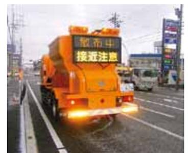
路面の凍結を防止する凍結防止剤散布車
