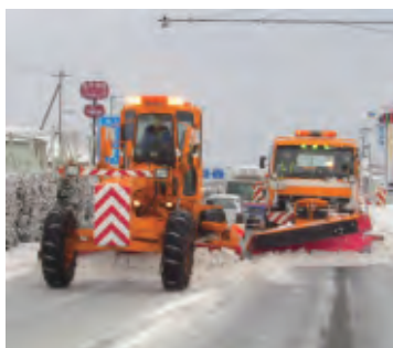
路面の積雪を排除する 除雪グレーダ・除雪トラック
