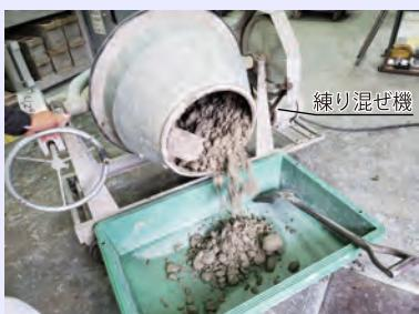
砂利や砂などの大きさ、セメントの種類、水、混和剤等の配合を変え練り上げ、何種類かの生コンクリートを作成
