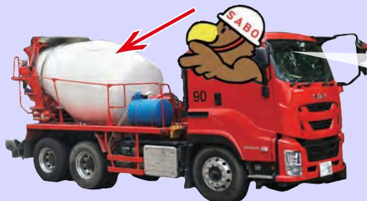
ミキサー部分が回転しているのは、荷下ろしまでの間の練り混ぜのムラを防ぐためなんだよ
