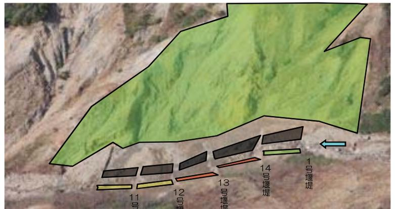
甚之助谷上流山腹工事は手取川水系牛首川上流部の既設堰堤5基（第11号堰堤、第12号堰堤、第13号堰堤、第14号堰堤、第1号堰堤）の右岸の法面の山腹対策工を行うものです。
