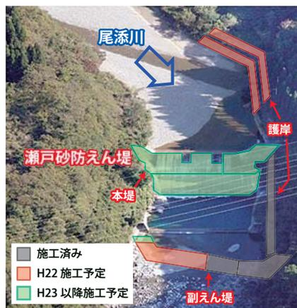
手取川の支川・尾添川での砂防事業は1927(昭和2)年に石川県により開始されています。尾添川の源流・中ノ川の上流は荒廃が非常に激しく、流出土砂が多いことと、昭和9年の手取川大洪水以降は洪水で堆積した土砂の二次流出による災害を防ぐため、より大型の砂防えん堤の築造が必要となったことから、1942(昭和17)年に国の直轄による砂防工事が開始されました。手取川ダムが完成した1980(昭和55)年以降は、ダムのある牛首川からは下流の金沢平野への土砂供給が無くなったため、尾添川では土石流などの急激な土砂流出は防ぎつつ、平常時には下流域に土砂を安定的に供給する事を考慮した透過型の砂防えん堤の整備が進められています。
